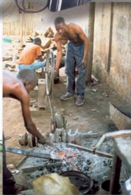
Waffenherstellung — Made in Africa: Die Mavumila Workshops im tansanischen Morogoro reparieren Fahrräder, Türschlösser und stellen sogar eigene Gewehre her. Die Esse mit dem radgetriebenen Gebläse ist schon ein Wunderwerk an afrikanischem Improvisationstalent.
